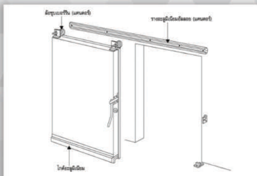
ประตูห้องเย็น
